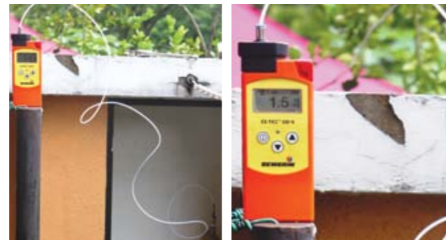
Pengukuran tahap odorant menggunakan Electrochemical Sensors dan contoh bacaannya.
