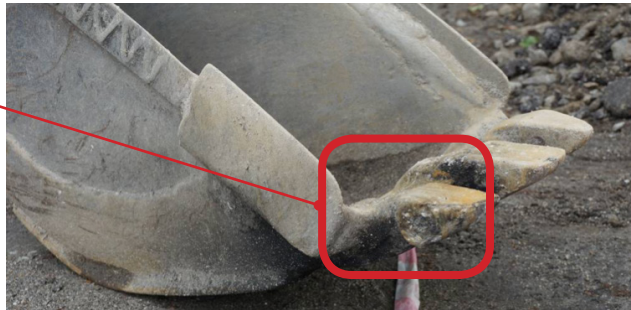
Gambar 14: Terdapat Kesan Hitam/Percikan Arka pada Bilah Jengkaut
